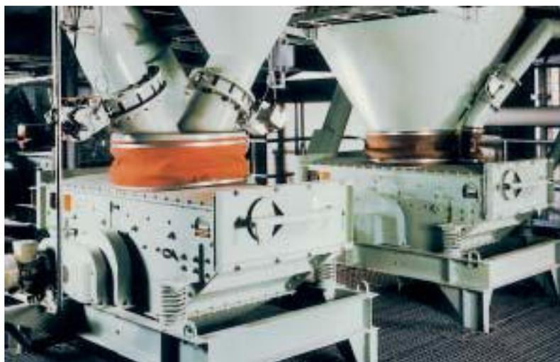
Самобалансный грохот марки «NIAGARA» на погрузочной установке, собранной фирмой IBAU.
